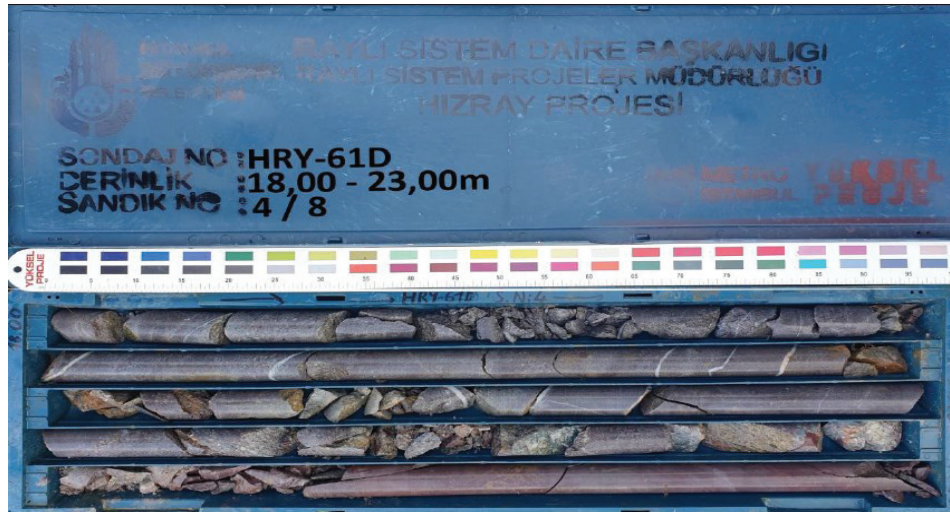
Şekil 5. Kurtköy Formasyonu Süreyyapaşa Üyesi'ne ait karot sandık fotoğrafı
