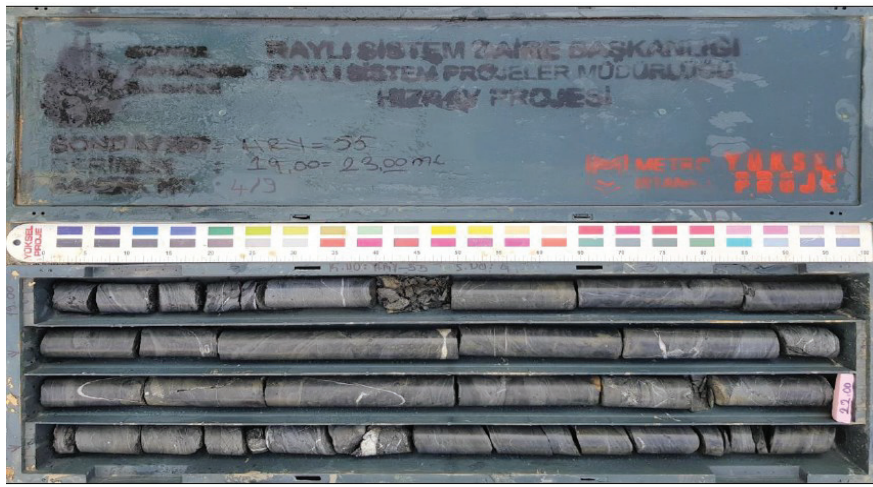
Şekil 7. Pelitli Formasyonu’na ait karot sandık fotoğrafı
