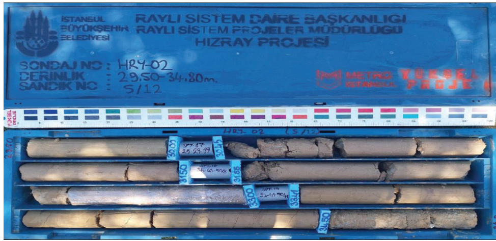
Şekil 13. Çekmece Formasyonu Çukurçeşme ve Güngören Üyesi'ne ait karot sandık fotoğrafı
