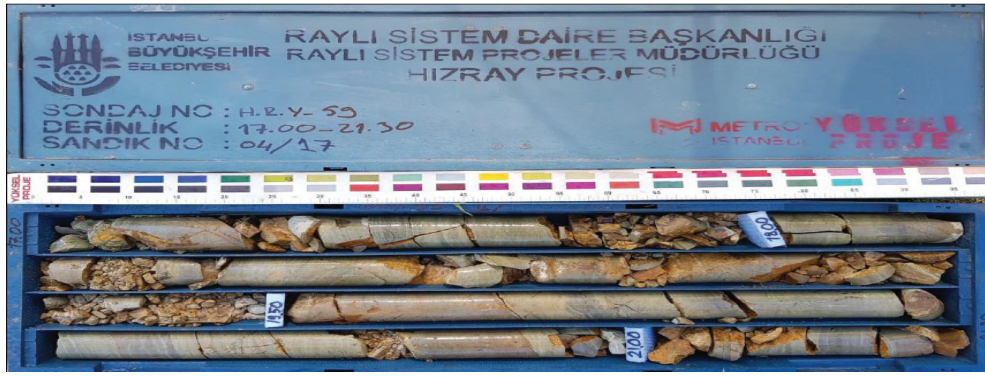
Şekil 4. Kurtköy Formasyonu Balacak Üyesi'ne ait karot sandık fotoğrafı
