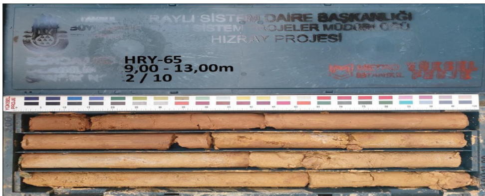
Şekil 14. Sultanbeyli Formasyonu ait karot sandık fotoğrafı
