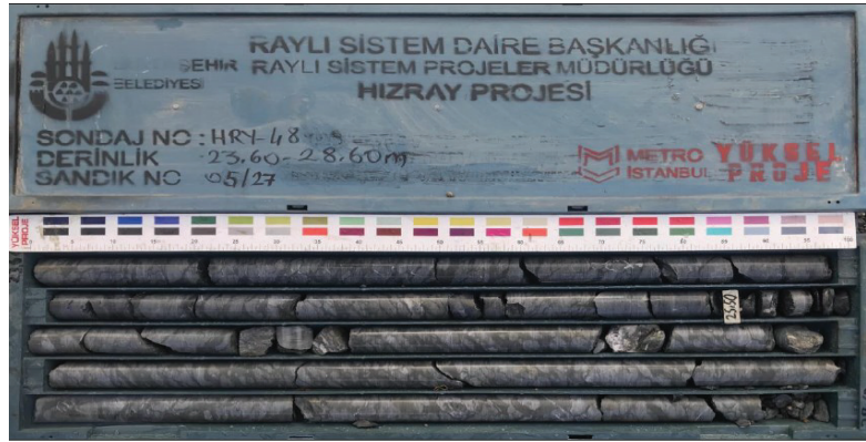
Şekil 9. Denizli Köyü Formasyonu Tuzla Kireçtaşı Üyesi'ne ait karot sandık fotoğrafı
