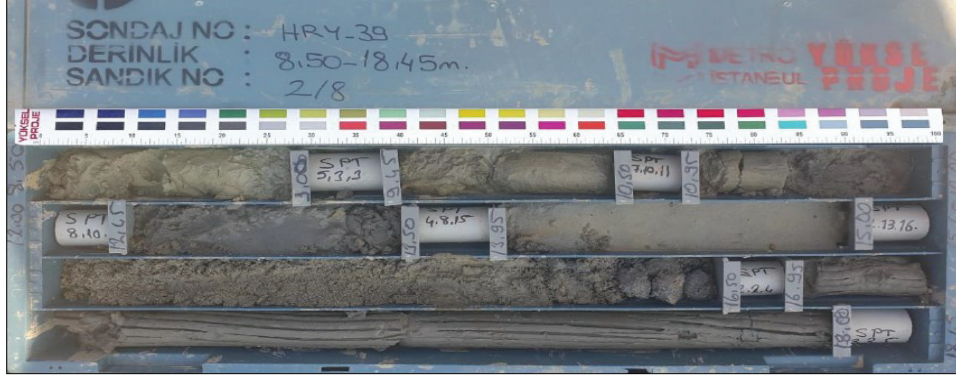
Şekil 15. Alüvyon seviyelerine ait karot sandık fotoğrafı
