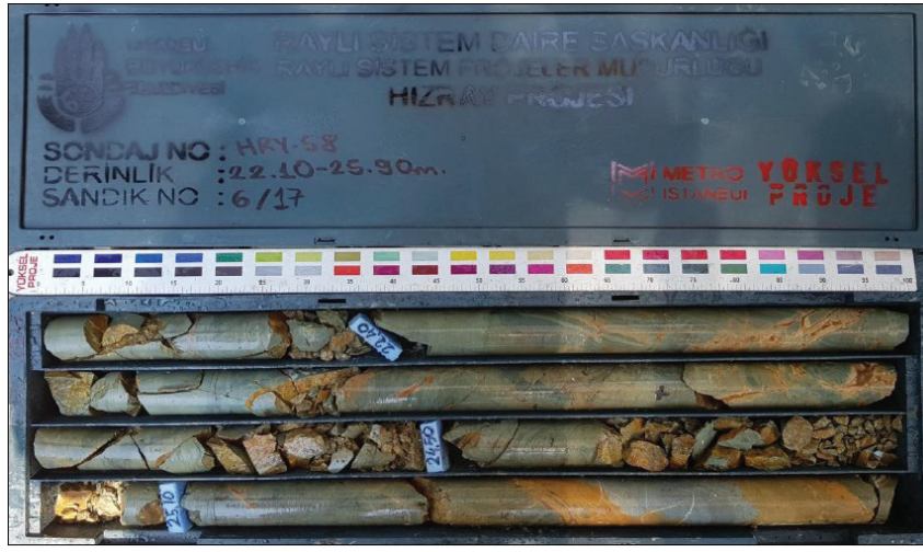
Şekil 2. Kocatöngel Formasyonu'na ait karot sandık fotoğrafı
