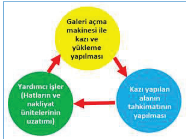
Şekil 5. Mekanize galeri açılması çalışmalarını genel iş akış şeması
