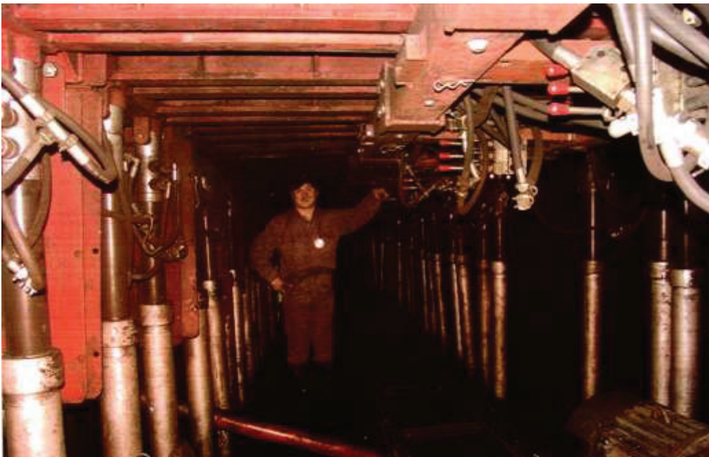
Şekil 2. Kirişli yarı mekanize tahkimat sistemi ayak içi görünümü
