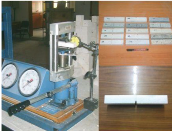
Şekil 3. SENB yöntemi kırılma tokluğu deneyi (Şengün, 2009)
