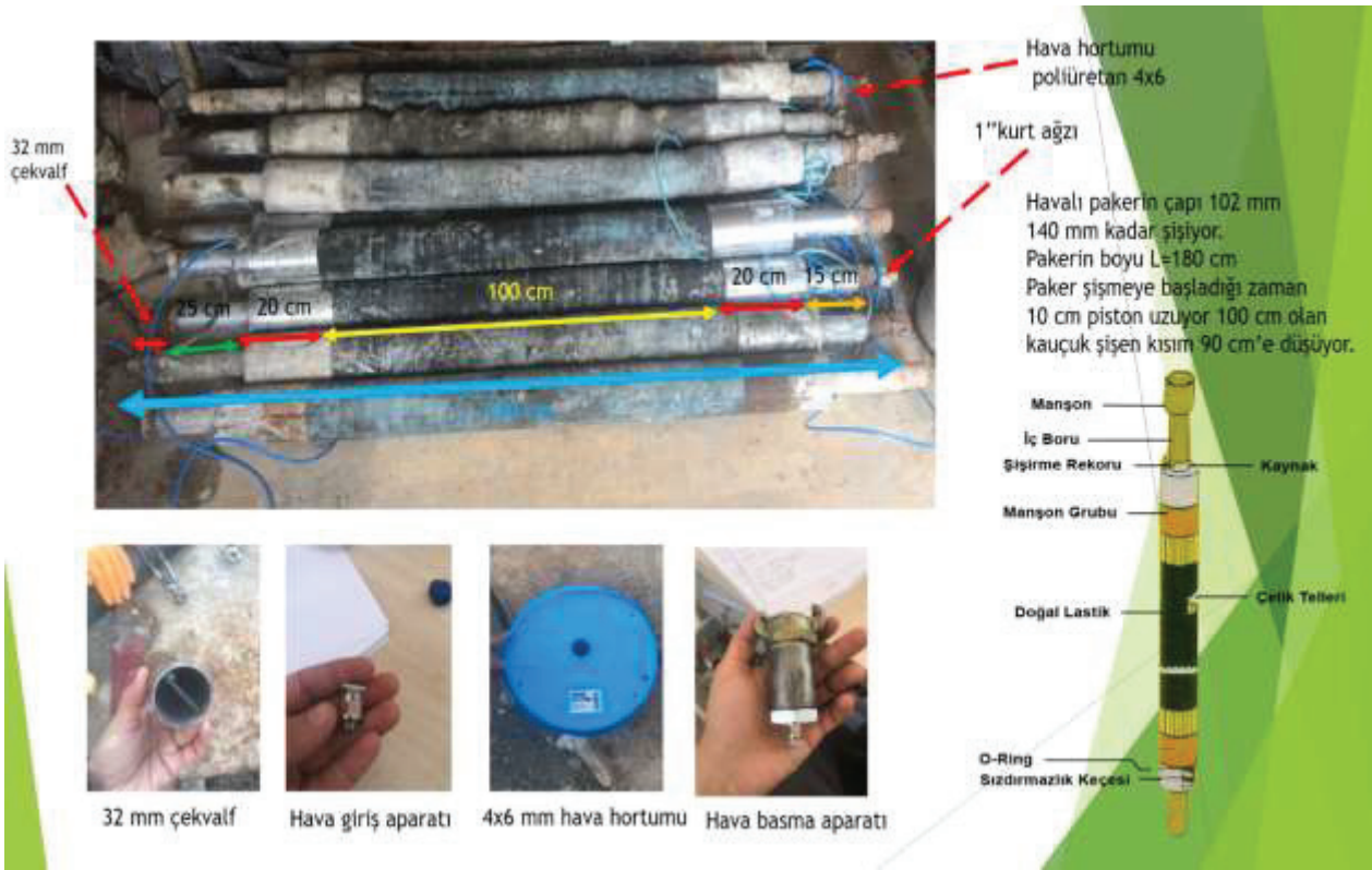
Şekil 8. Hidrolik Paker ve aparatları
