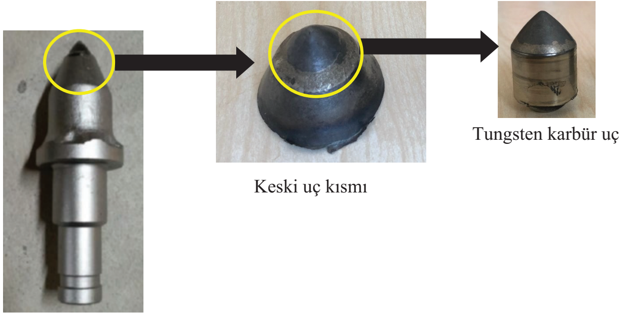
Şekil 1. Konik keskideki tungsten karbür uç
