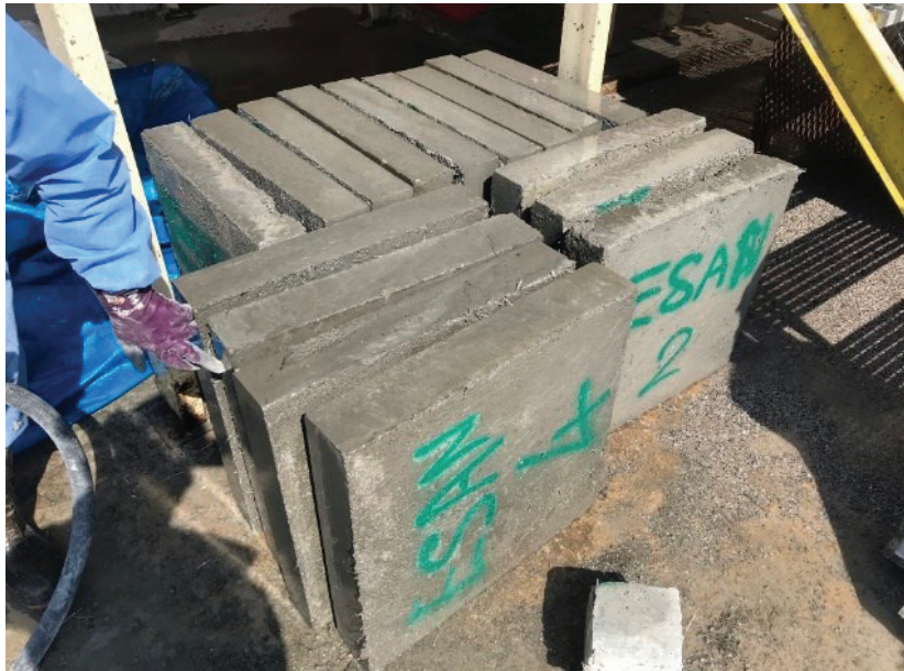
Şekil 5. Kalıptan çıkartılan örnek panel numuneler
