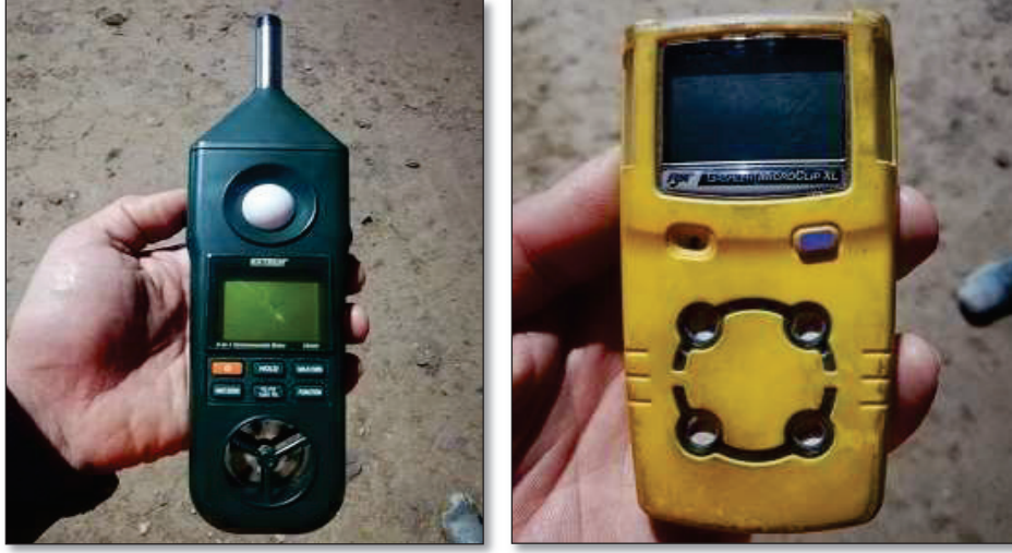
Şekil 3. Extech çoklu ölçüm ve Honeywell gaz konsantrasyon ölçüm cihazı
