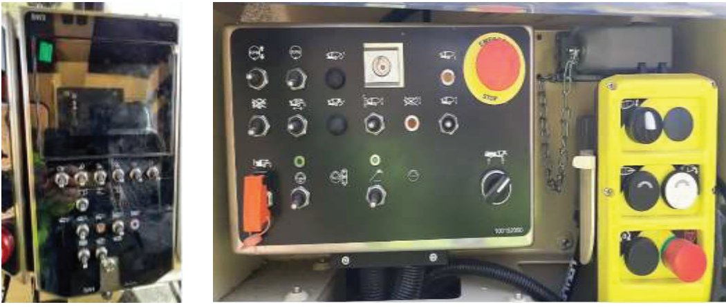
Şekil 4. Kabin içi ve yan gövde tambur kontrol paneli, uzaktan kumanda
