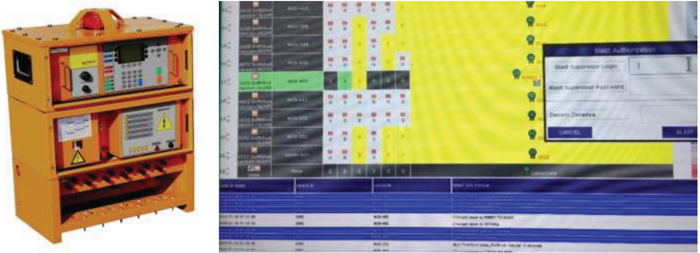
Şekil 3. Patlatma kontrol ünitesi ve BlastWeb merkezi elektronik ateşleme sistemi arayüzü
