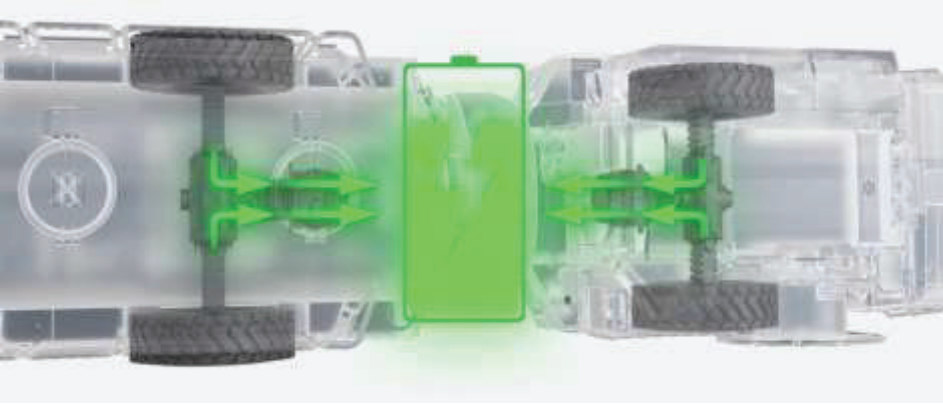
Şekil 3. Ekipman üzerinde yer alan elektrik motorların konumu
