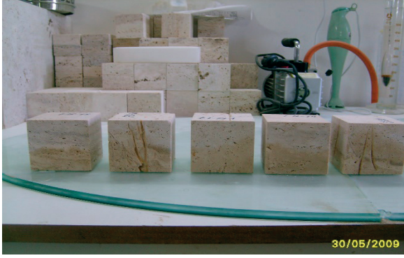
Şekil 4b. Kapiler su emme deneyi sırasında tabandan su almış örneklerin görünüşleri.
