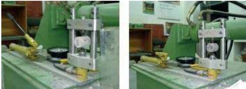
Şekil 1. Nokta yükleme deney düzeneği
