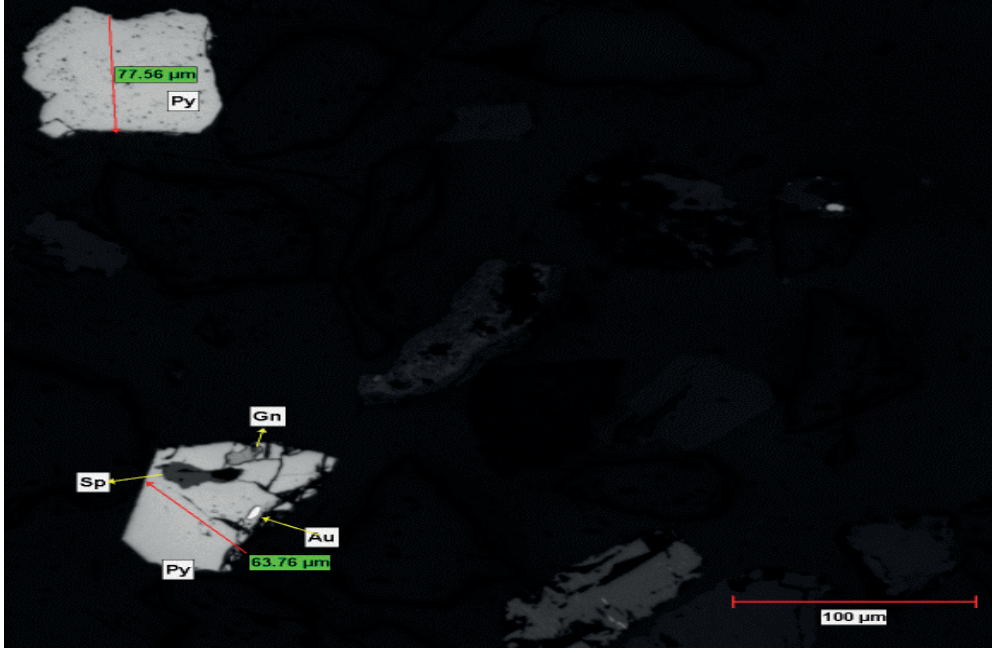
Şekil 2. + 0,090 mm fraksiyonun 50× mercekte altında görüntüsü
