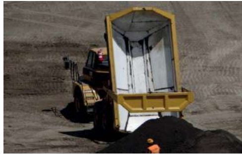
Şekil 36. Polimer ile kaplanmış kamyon damperi
