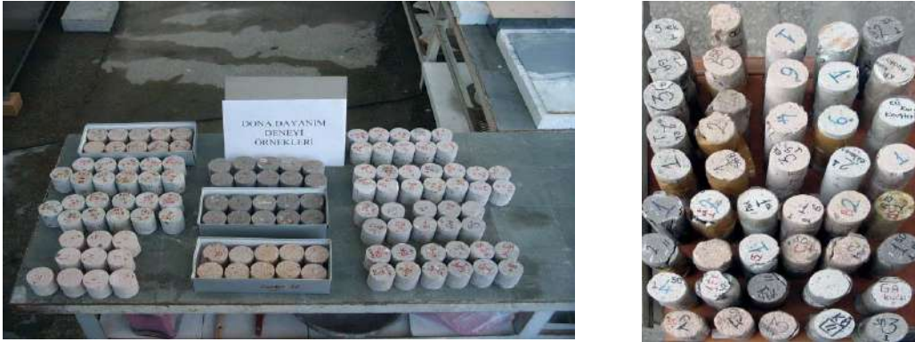
Şekil 6. Tek eksenli basınç dayanımı için kullanılan örnekler.
