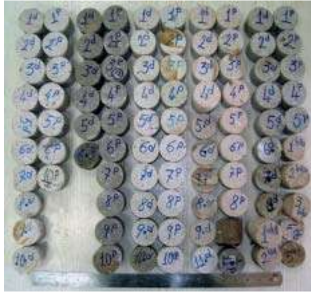
Şekil 5. Nokta yükleme deneyinde kullanılan örnekler.
