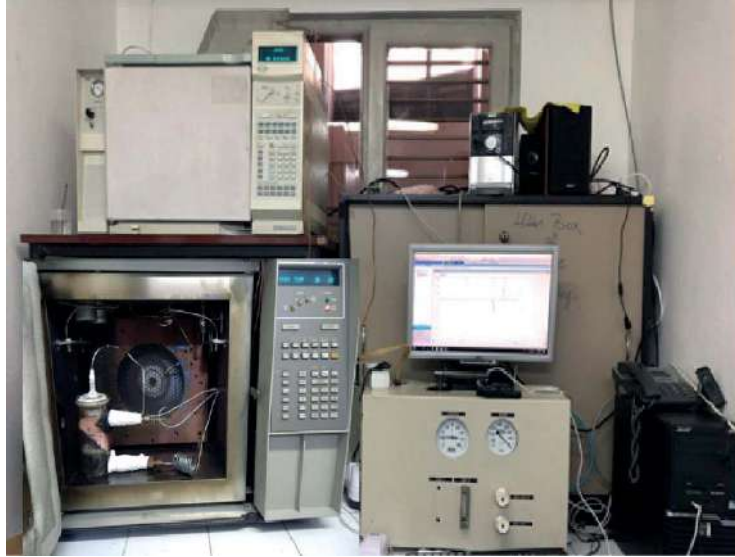
Şekil 12. Numunenin kendiliğinden yanma fırınına ve reaktöre yerleştirilmesi ve gerekli hava bağlantılarının tamamlanmasına ait görsel.
