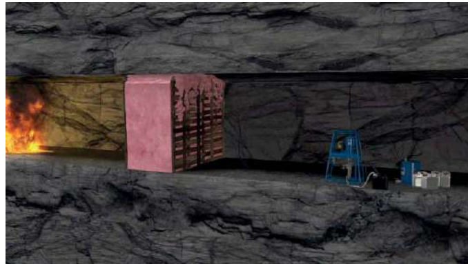
Şekil 5: Yangın bölgelerine köpük barajı yapılması (Weber Madencilik, 2019)
