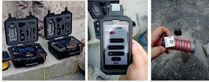
Şekil 4. Elektronik kapsüllerin saha uygulamasından bir görüntü
