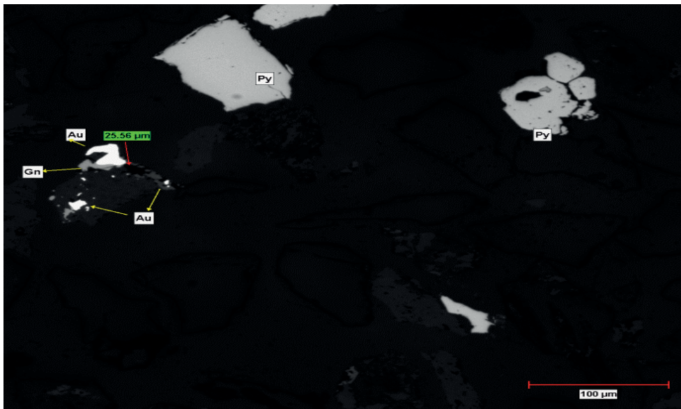
Şekil 1. + 0,106 mm fraksiyonun 50× mercekle altında görüntüsü
