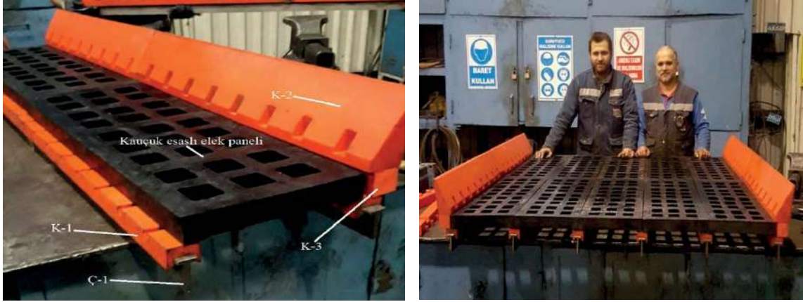
Şekil 7. Kauçuk esaslı elek paneli ve bağlantı elemanlarının gösterimi
