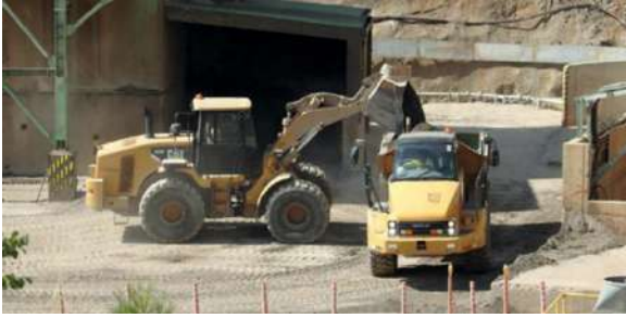
Şekil 2. Filtrelenmiş atığın kamyonu yüklenmesi
