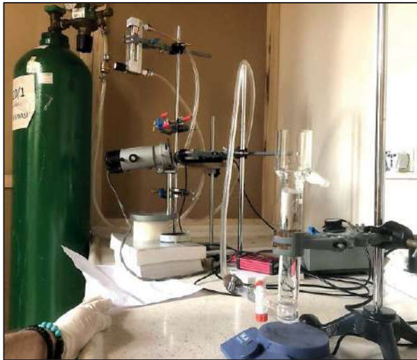
Şekil 6. Mikro-flotasyon deney düzeneği ve örnek bir deney
