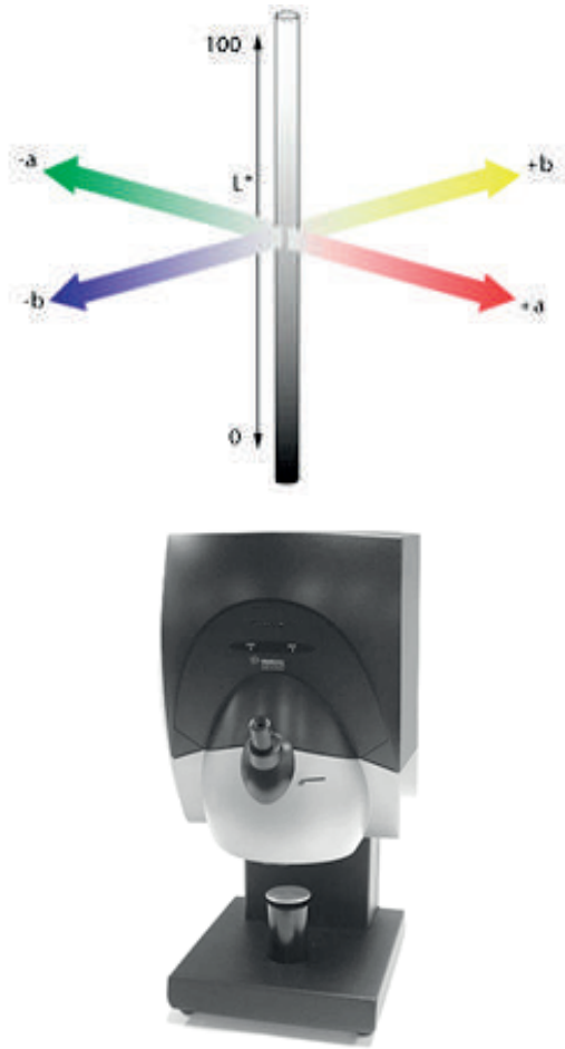
Şekil 3. CIELAB renk koordinat sistemi ve renk tayini cihazı (Datacolor, 2019)
