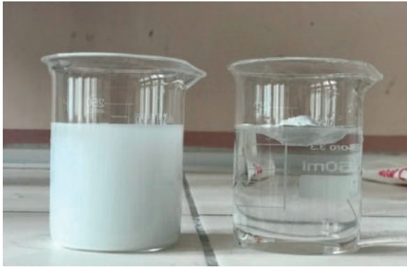
Şekil 4. Suya bırakılan kaplanmamış (solda) ve kaplanmış (sağda) mikronize kalsitin davranışı
