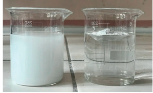
Şekil 6. Kaplama öncesi (solda) ve kaplama sonrası (sağda) mikronize kalsit görünümü
